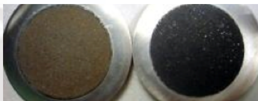
Contaminación severa causada por mezcla de anticongelantes
