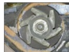
Ancongelantes incompatibles y daño en el sello por anticongelantes contaminados
